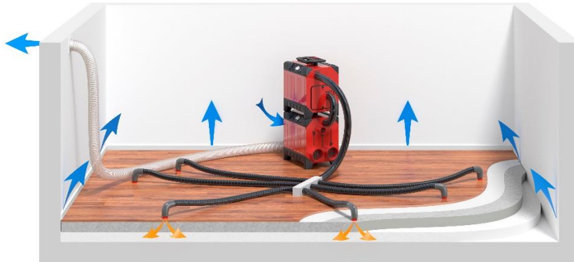
Drogen met geforceerde lucht. De turbine wordt gevoed met droge lucht uit de droger en drukt de lucht in de gelaagde constructie.
