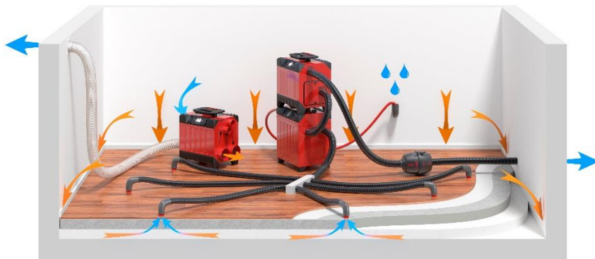
Vacuümdrogen. De droger droogt de omgevingslucht en de turbines zuigen de lucht uit de constructie om deze af te voeren. De ontstane onderdruk in de constructie zuigt de droge lucht op.
